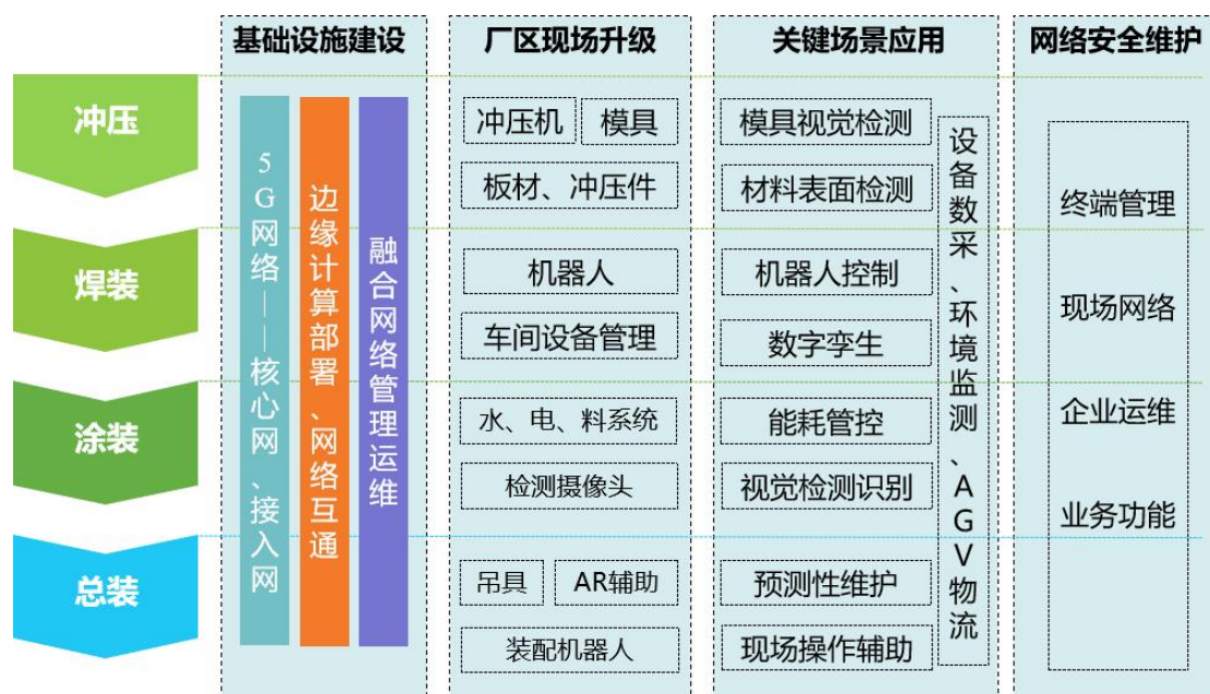
图 3-1 汽车制造业 5G 工厂建设实施架构
