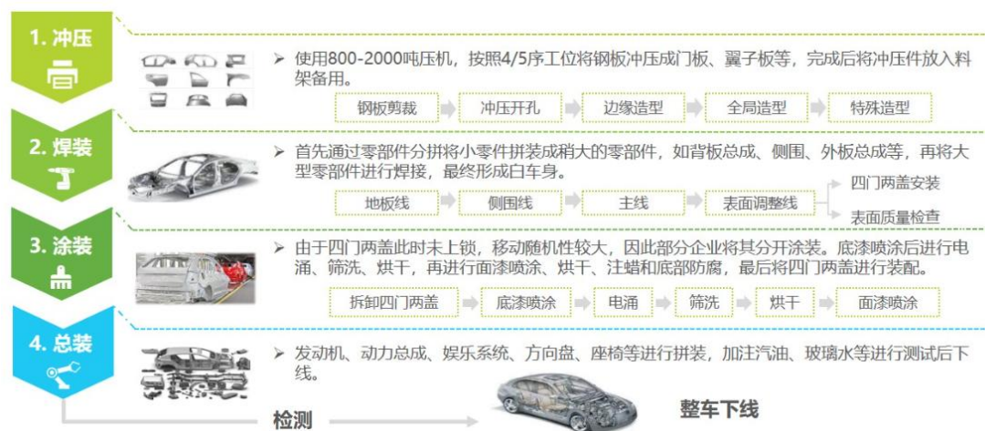
图 2-1 汽车四大工艺流程图
