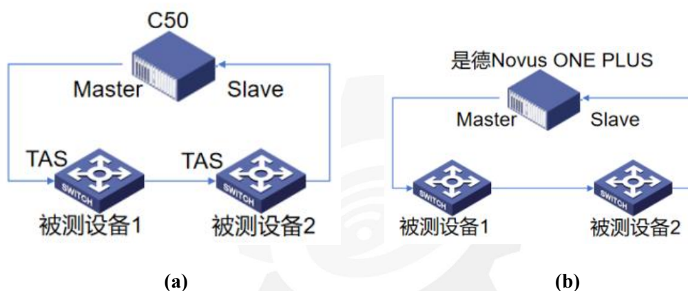
图 2-3 使用(a)思博伦 C50, (b)是德 Novus ONE PLUS 进行门控调度测试
