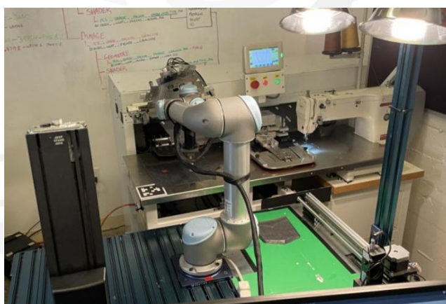
图 2-3 先进机器人制造研究所（ARM）开发的服装生产协作机器人
