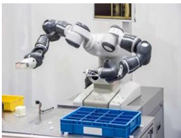
图 2-4 政府项目支持下，中小企业横滨电子引入的分拣协作机器人
