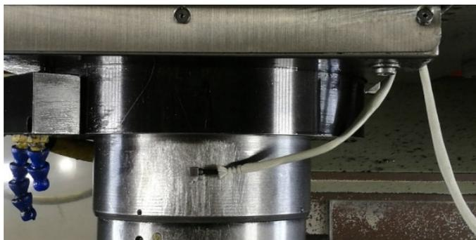
图 1-1-1 振动传感器安装位置及方向
