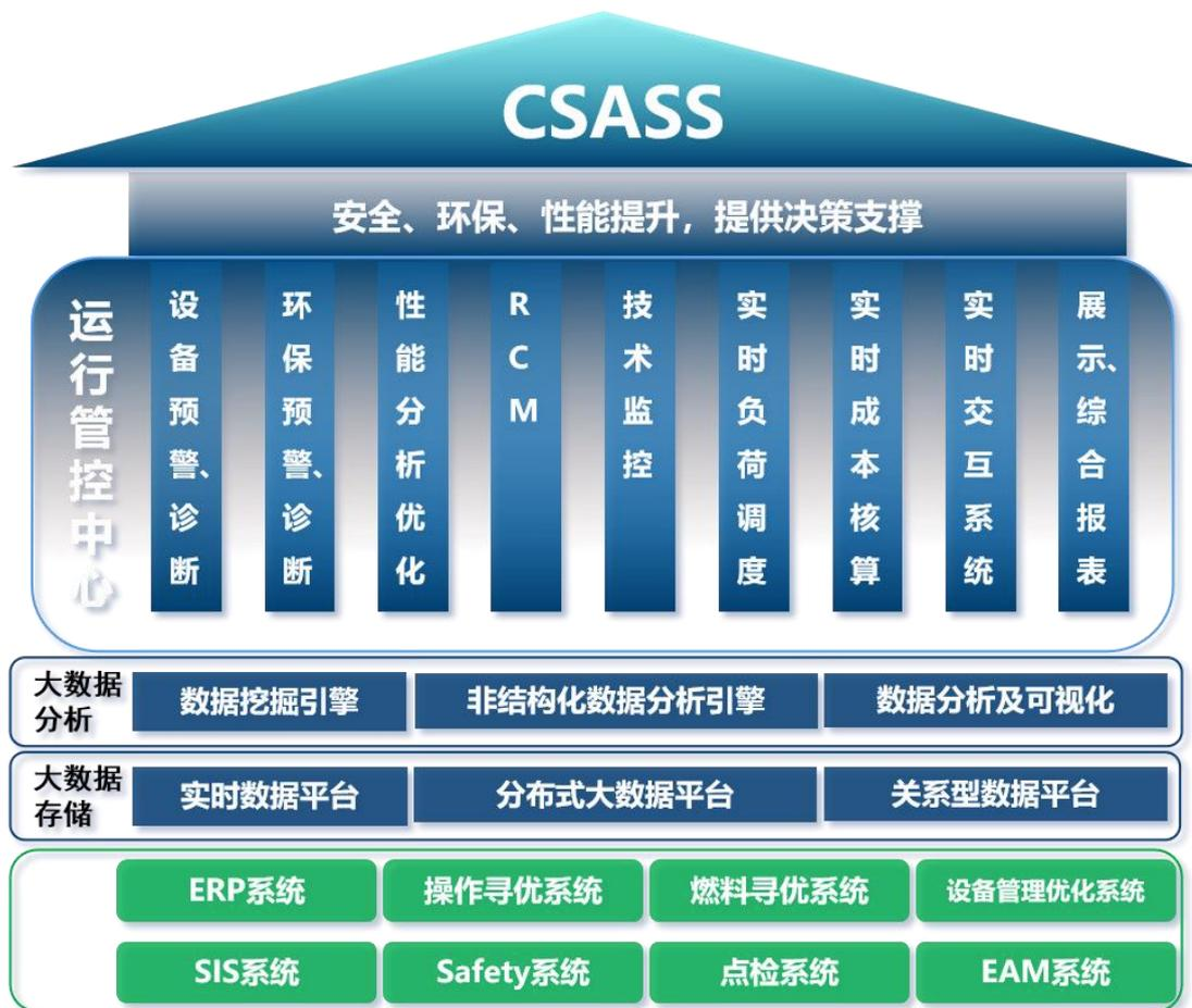
图 1 CSASS 系统架构图
