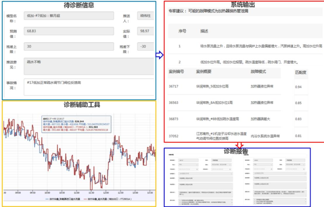
图 17 低加疏水阀位反馈异常诊断
