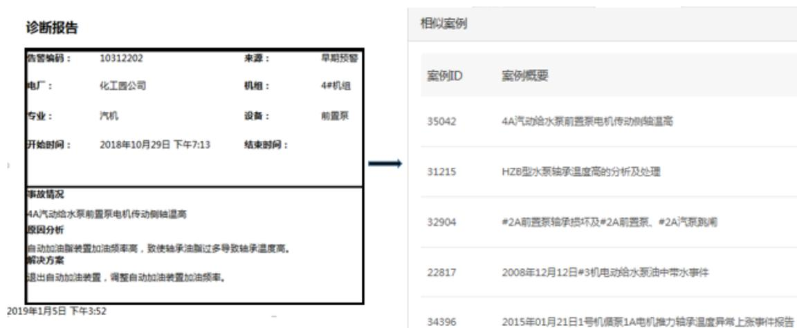
图 16 电机轴承温度高诊断案例
