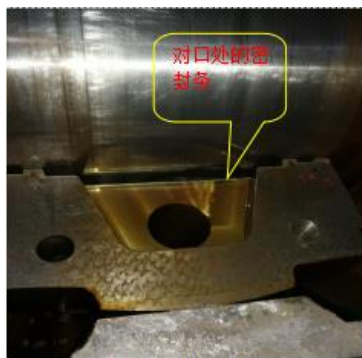
图 1:1 瓦对口处的密封条
