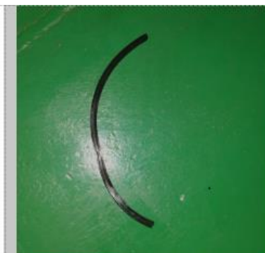
图 2:1 瓦对口处取出的橡胶密封条
