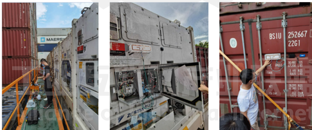
图 7：箱式集装箱卫星终端安装示意图
