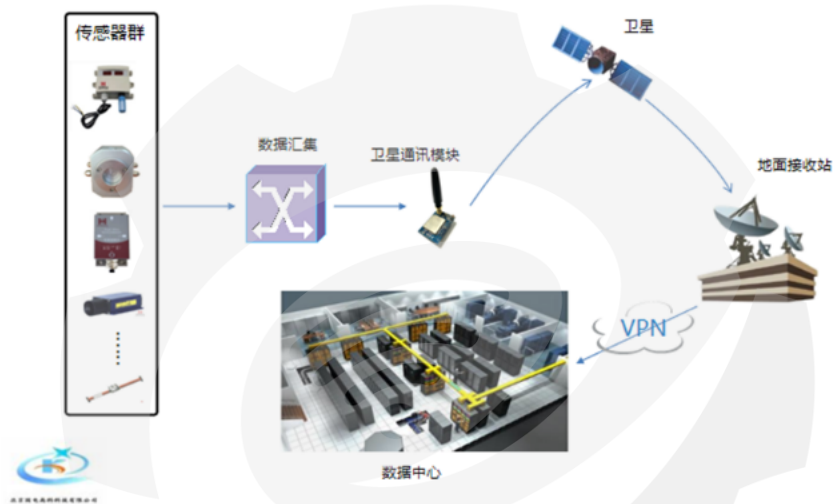
图 4：系统的数据传输架构示意图
