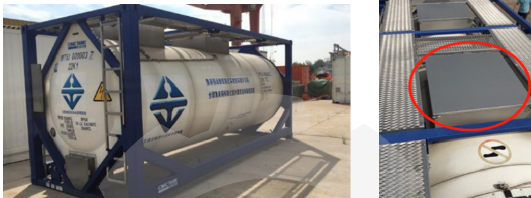
图 6：罐式集装箱卫星终端安装示意图
