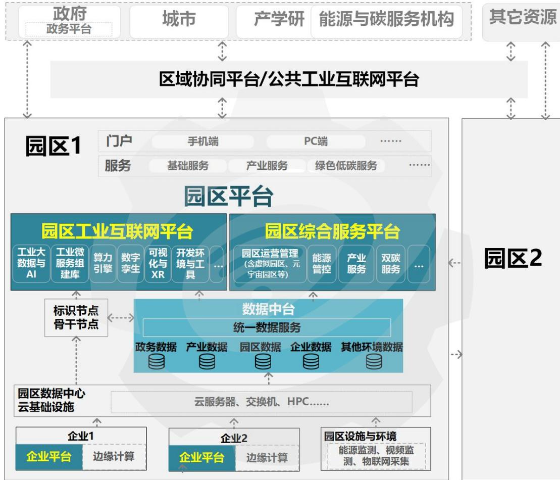
图5 工业互联网园区平台架构
