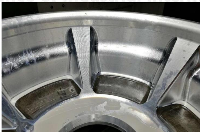
图 30 汽车轮毂粗加工（优化后）
