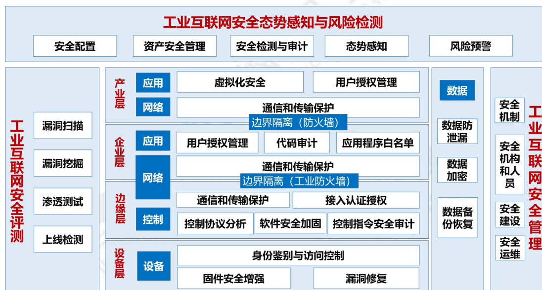
图 7-1 钢铁行业工业互联网安全功能架构
